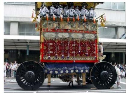
schwierig zu lenken. Dies geschieht durch Keile, die während der Fahrt zur Regulierung der Fahrtrichtung unter die Räder geschoben werden.
